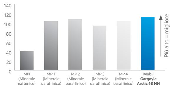
L'olio Mobil Gargoyle Arctic 68 NH raggiunge l'indice di viscosità massimo definito da ASTM D 2270
