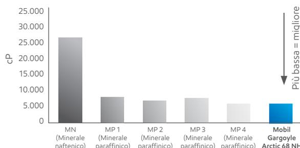
Mobil Gargoyle™ Arctic 68 NH è un olio refrigerante ad alte prestazioni formulato specificamente per la lubrificazione di compressori di refrigerazione alternativi e a vite che utilizzano ammoniaca (NH<sub>3</sub>, R-717). Utilizza una tecnologia paraffinica minerale di alta qualità che offre i seguenti vantaggi<sup>1</sup> a chi lo utilizza:
