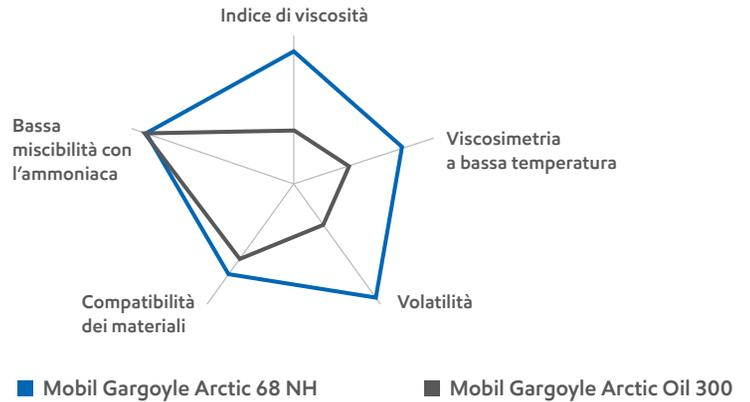
Considerazioni sull'applicazione: l'olio Mobil Gargoyle Arctic 68 NH è indicato per l'utilizzo negli impianti di refrigerazione per la lubrificazione di cilindri e cuscinetti dei compressori di refrigerazione alternativi e a vite convenzionali in cui viene usato refrigerante ad ammoniaca. Tra le applicazioni:
